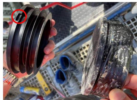
Abbildung 3: Einweg Betonaustrittsdeckel Standard, Neu vs. Alt (mit Klebeband)
